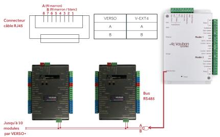
Vous pouvez également utiliser les borniers A et B des modules V-EXT4+ pour raccorder votre bus RS485.
