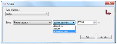
Pour un type « Sortie Externe », sélectionnez un relais d'un module V-EXTIO que vous pourrez Activer, Désactiver, Inverser ou Activer pendant un temps de 1 à 65534 secondes.
