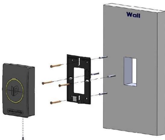
Socle compatible pots électriques 60 et 62 mm
